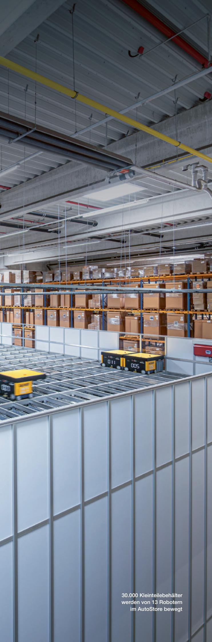
30.000 Kleinteilebehälter werden von 13 Robotern im AutoStore bewegt
